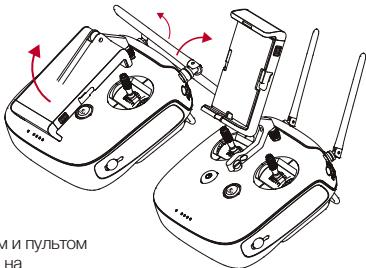
Сигнал передачи между летательным аппаратом и пультом дистанционного управления наиболее стабилен на указанном расстоянии. Чтобы оптимизировать мощность сигнала при ее недостатке, отрегулируйте положение антенн и направьте летательный аппарат ближе к пульту.
